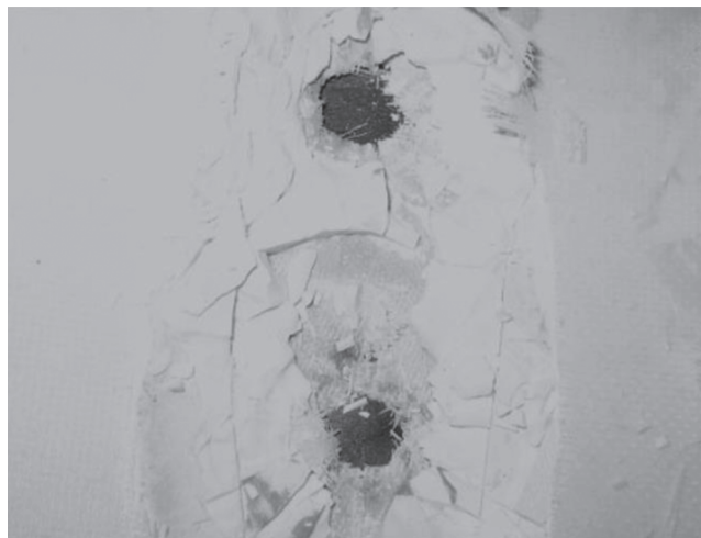
Рис. 2. Образование трещин на керамической пластине AM2 после выстрела (пуля 7.62 · 51 мм).
