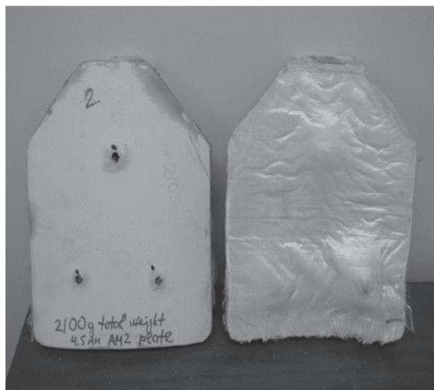
Рис. 1. Трещины в баллистических сжатых керамических пластинах.
