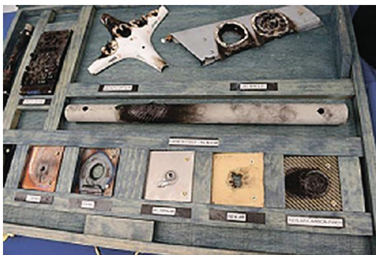
Рис. 8. Результат воздействия боевых лазеров на различные материалы.
