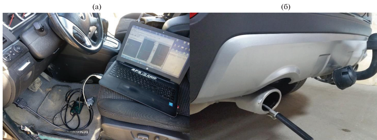
Рис. 5. Подготовительные операции перед испытаниями: а — процесс чип-тюнинга двигателя, б — установка зонда газоанализатора в глушитель выпускной магистрали двигателя.
