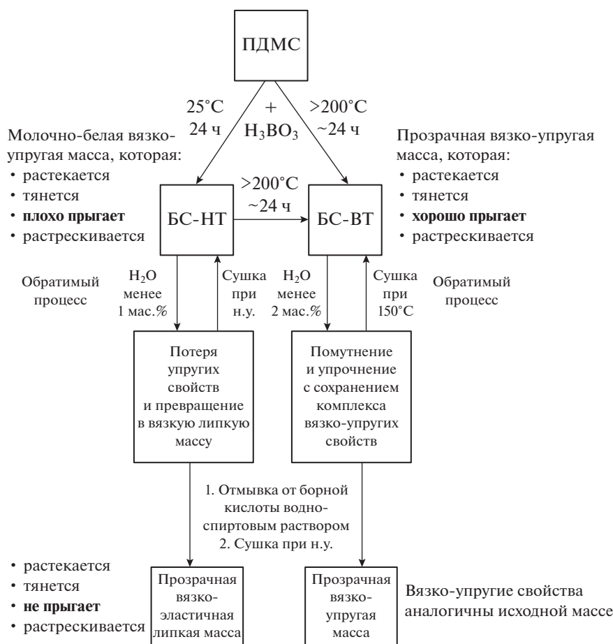
Рис. 1. Схема получения образцов БС и краткая характеристика их свойств.
