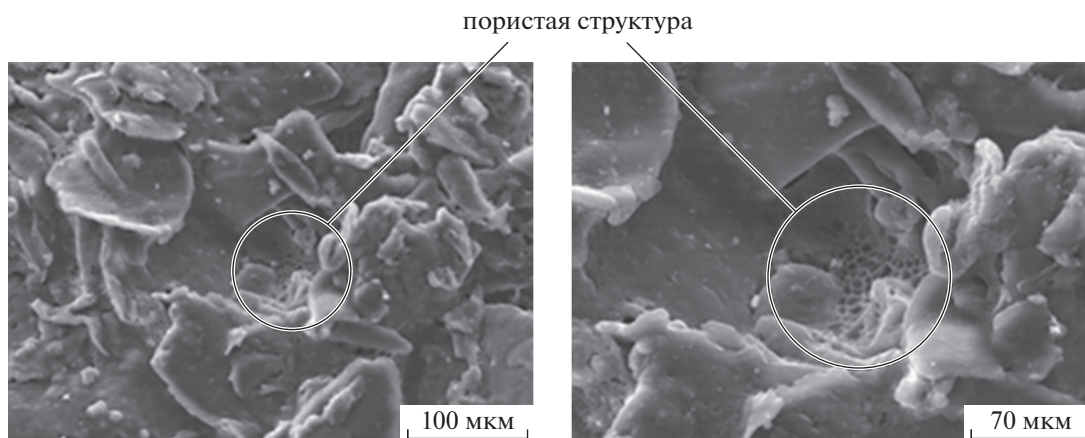
Рис. 9. Микрофотографии поверхности пленок композиции ПЛА–ПГБ–хитозан с соотношением компонентов 25 : 25 : 50 мас. %, полученные методом СЭМ.
