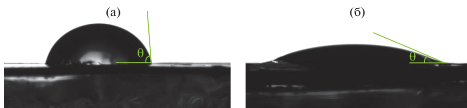
Рис. 4. Определение угла смачивания водой ПЭ-подложки (а) и композита арабиногалактан–ПЭ-2, полученного из 20%-ного раствора арабиногалактана (б).
