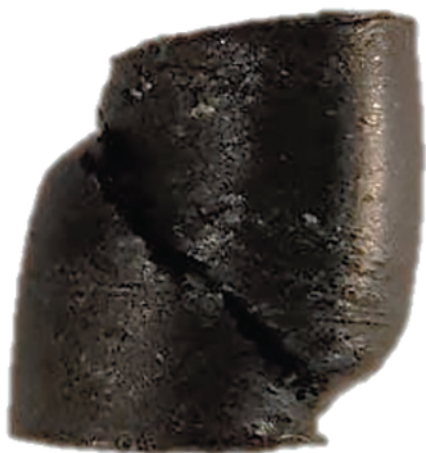
Рис. 7. Полоса сдвига в сверхвысокомолекулярном ПЭ, содержащем 2 мас. % графена.
