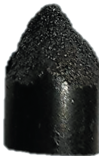
Рис. 5. Фотография цилиндрического образца композита ПВХ-восстановленный оксид графена (1%), разрушенного под действием сжимающей нагрузки.
