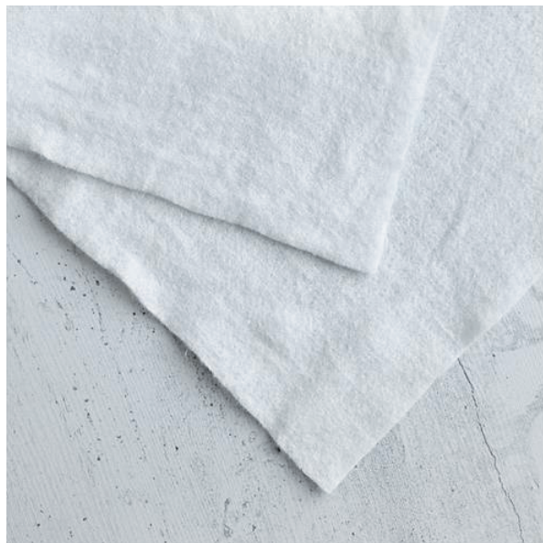
Рис. 2. Фотография нетканого материала, содержащего 70% льняной волокнистой целлюлозы и 30% вискозных штапельных волокон.
