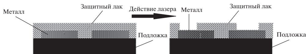
Рис. 1. Схема структурирования поверхности с помощью луча лазера для нанесения токопроводящих электрических элементов печатных плат.
