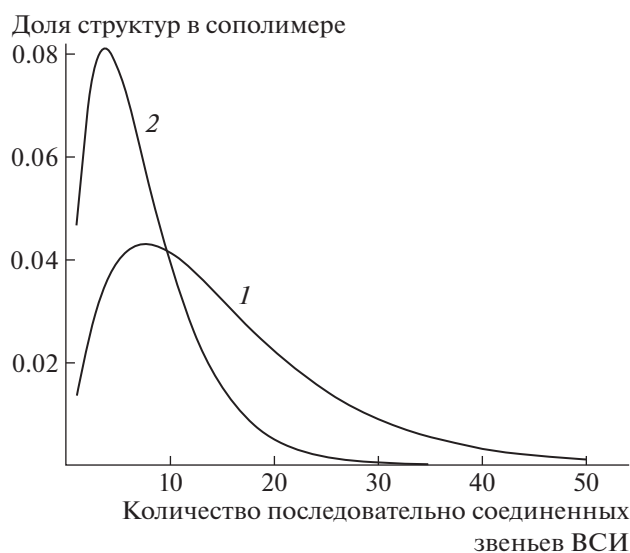
Рис. 7. Зависимость доли последовательностей звеньев ВСИ в цепи сополимера ВСИ с ВА от их длины. Содержание ВСИ в смеси 90 (1) и 80 мол. % (2).
