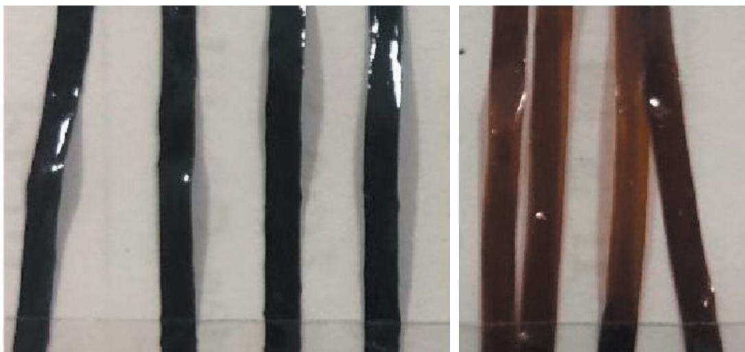
Рис. 3. Пленки P-СОД (а) и нанокompозита P-СОД+CeO 2 (б) после термообработки при 500°С.
