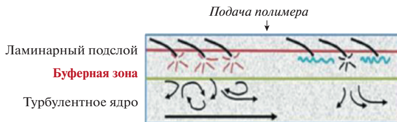
Рис. 7. Характер турбулентного течения в отсутствие полимера (слева) и при введении полимера в поток (справа) по [25].
