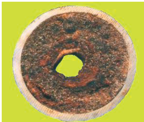
Рис. 17. Вид сечения трубы с наростами на стенках кристаллами парафинов.
