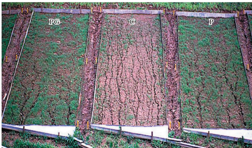
Рис. 1. Защита почвы путем нанесения водной суспензии ПАМ–гипс (слева), воды (в центре, контроль) и водного раствора ПАМ (справа). Использовано с разрешения издательства “American Society of Agricultural and Biological Engineers”, copyright D.C. Flanagan et al. (2002) [45].
