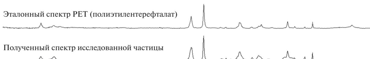
**Рис. 6.** Полосы комбинационного рассеяния на полученном спектре, соответствующие колебанию молекулярных связей в полиэтилентерефталате.
