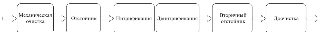
**Рис. 2.** Схема биологической очистки с удалением азота.
