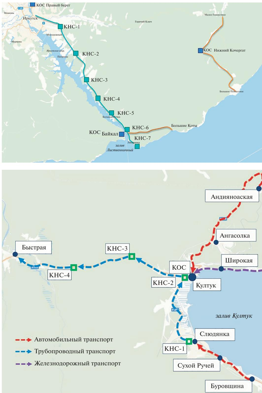
Рис. 4. Рекомендуемые схемы водоотведения в средней (вверху) и южной (внизу) зонах оз. Байкал.
