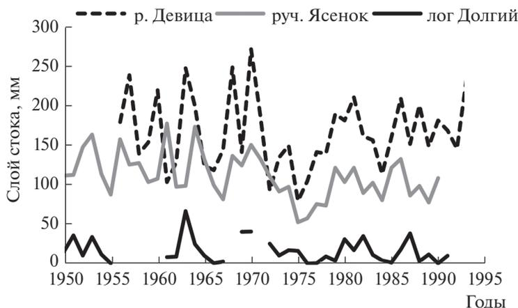
**Рис. 14.** Многолетние изменения годового стока воды на водотоках Нижнедевицкой ВБС (р. Девица – п. Товарня,  $F = 103 \text{ км}^2$ ; руч. Ясенок,  $F = 21.7 \text{ км}^2$ , закрыт в 1990 г.; лог Долгий,  $F = 2.57 \text{ км}^2$ , в последние десятилетия сток воды наблюдался спорадически в отдельные годы).
