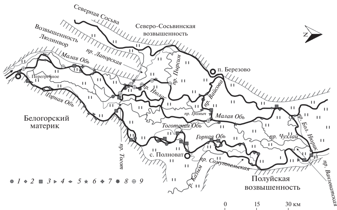
Рис. 5. Изменение мутности, \text{г/м}^3 , по длине в раздвоенном русле нижней Оби: 1 — <30 \text{ г/м}^3 , 2 — от 30 до 33, 3 — от 33 до 36, 4 — от 36 до 39, 5 — от 39 до 42, 6 — от 42 до 45, 7 — от 45 до 48, 8 — от 48 до 51, 9 — >51 \text{ г/м}^3 .
