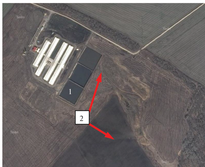
Рис. 4. Космический снимок типичного животноводческого комплекса в Пристенском районе Курской области восточнее с. Верхняя Ольшанка в верховьях р. Псёл. 1 — пруды-отстойники свинофермы; 2 — промоины на пашне (внизу) и на участке склона около прудов отстойников.
