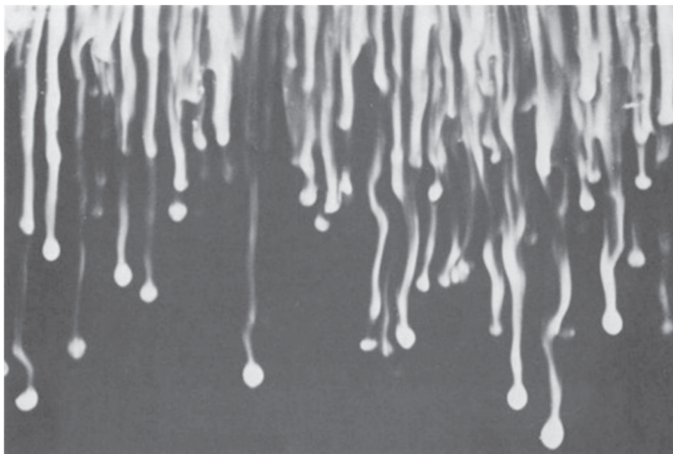
Рис. 2. Ансамбль термиков в форме тяжелых солевых пальцев, опускающихся в водяном слое, согласно [13]. Нисходящее движение термиков визуализируется добавлением в соль флуоресцеина и освещением через щель.
