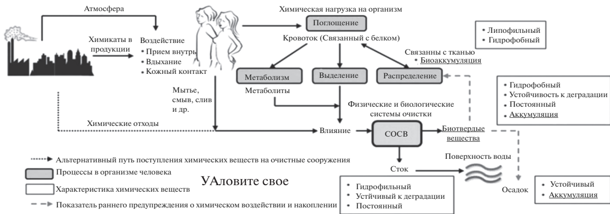
Рис. 8. Миграция и трансформация искусственно синтезированных химических веществ в антропогенной среде [51]. СОСВ – станция очистки сточных вод.
