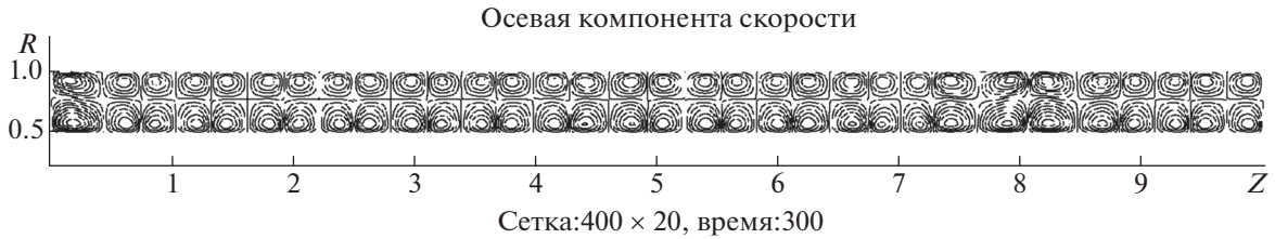
Фиг. 1. Формирование регулярной структуры возмущений при \omega = 0 , Re = 300 , M = 0.1 .
