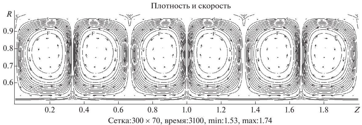
Фиг. 3. Установившаяся вихревая структура при \omega = 0 , Re = 300 , M = 0.1 .
