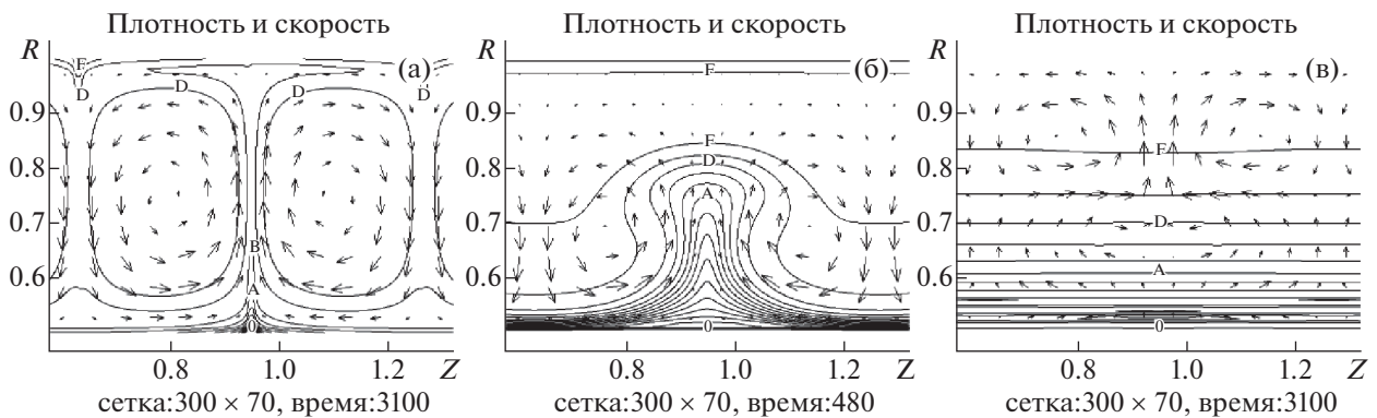
Фиг. 4. Течения при Re = 300 , M = 0.1 : (а) \omega = 0.23 , (б), (в) \omega = 0.26 .
