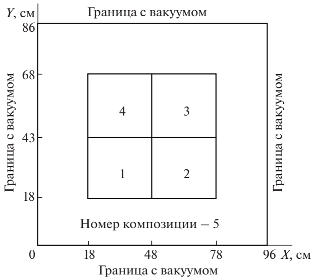
Фиг. 1. Сечение 3D расчетной области тестовой задачи EIR2 [5] в x, y, z геометрии при 18 < z < 78 . Области 0 < z < 18 и 78 < z < 96 заполнены материалом 5 в пределах 0 < x < 96, 0 < y < 86 .
