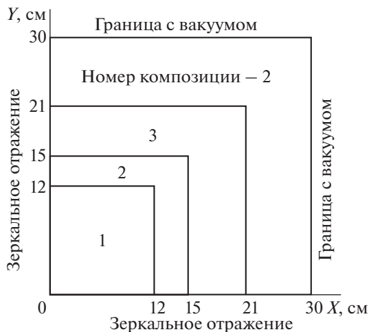
Фиг. 2. Сечение 3D железо-водной композиции [5] в x, y, z геометрии при 0 < z < 12 . Расположение зон и источника по оси z повторяет их расположение по осям x и y (композиция полностью симметрична по переменным x, y и z ).
