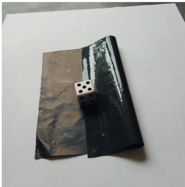
Рис. 1. Фотография пленки композита ПТФЭ/МГНП.
