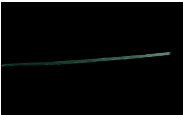
Рис. 5. Кадр видеозаписи излучения из продольной прорези в трубе, заполненной излучением воздуха. Источник света (упомянутая выше ксеноновая лампа) расположен справа от прорези, помещенной на фото. Видно, что интенсивность излучения падает вдвое на длине порядка 10 см. Отсюда следует, что на длине трубы 80 см из спектра излучения ксеноновой лампы исчезает весь свет, попадающий в полосы поглощения димольных комплексов кислорода. Интенсивность света с указанными свойствами можно оценить величиной 0.025 от мощности лампы, что в случае применения лампы мощностью 35 Вт составляет примерно 1 Вт.
