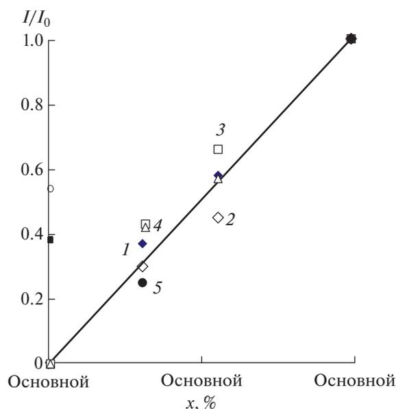
**Рис. 2.** Зависимость относительной интенсивности люминесценции смешанных комплексов  $\text{Eu}_x/\text{Gd}_{100-x}(\text{TТА})_3\text{Phen}$  от содержания иона  $\text{Eu}^{3+}$  (x, %) в пленках ПММА. Концентрация комплексов 0.6 (1), 0.9 (2), 1.25 (3), 3.8 ммоль/кг (4), 15 ммоль/л (5).
