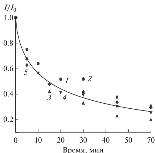
**Рис. 4.** Кинетика изменения относительной интенсивности люминесценции комплекса  $\text{Eu}(\text{TTA})_3\text{Phen}$  в пленках ПММА при облучении образцов с одинаковой оптической плотностью (0.25 при  $\lambda = 365$  нм), но с различной толщиной пленок (10–100 мкм) и концентрацией комплексов (0.6–6 ммоль/кг) (точки 1–4). Лампа ДРШ-1000,  $\lambda > 320$  нм.
