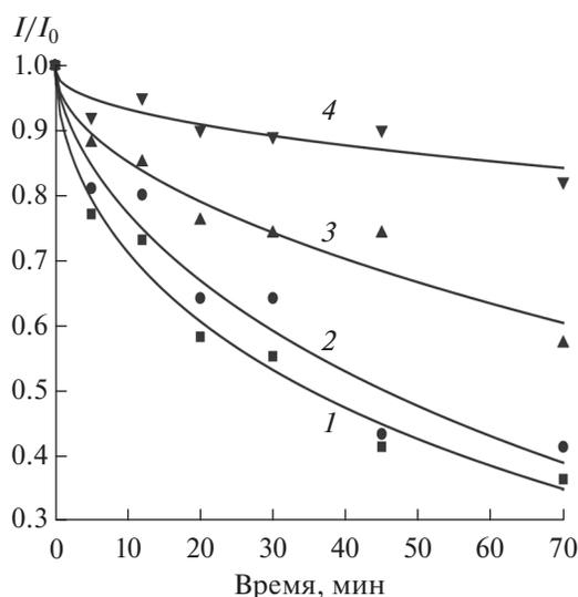
**Рис. 3.** Кинетические кривые уменьшения относительной интенсивности люминесценции комплекса  $\text{Eu}_x/\text{Gd}_{100-x}(\text{TTA})_3\text{Phen}$  с содержанием европия 31% в пленках ПММА при облучении на воздухе светом лампы ДРШ-1000 с  $\lambda > 320$  нм. Концентрации комплекса 0.3 (1), 0.6 (2), 1.2 (3), 2.5 ммоль/кг (4), толщина пленок 60 мкм.
