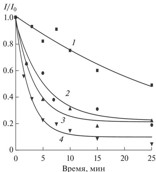
**Рис. 6.** Влияние гадолиния на светостойкость смешанных комплексов  $\text{Eu}_x/\text{Gd}_{100-x}(\text{TТА})_3\text{Phen}$  в пленках ПЭ. Содержание гадолиния 100 (1), 56 (2), 31 (3) или 0.6% (4). Облучение светом лампы ДРШ-1000 с  $\lambda > 280$  нм, толщина пленок 90 мкм, концентрация комплексов 2.0 ммоль/кг.
