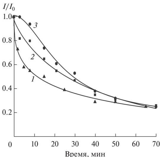
**Рис. 5.** Влияние содержания гадолиния на светостойкость комплексов  $\text{Eu}(\text{TТА})_3\text{Phen}$  (1) и  $\text{Eu}_x/\text{Gd}_{100-x}(\text{TТА})_3\text{Phen}$  (2, 3) в пленках ПММА при облучении светом лампы ДРШ-1000,  $\lambda > 320$  нм. Содержание европия 100 (1), 56 (2) или 31% (3), концентрация комплексов 0.6 ммоль/кг.
