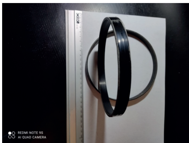
Рис. 1. Образец кольца из базальтового композитного материала.
