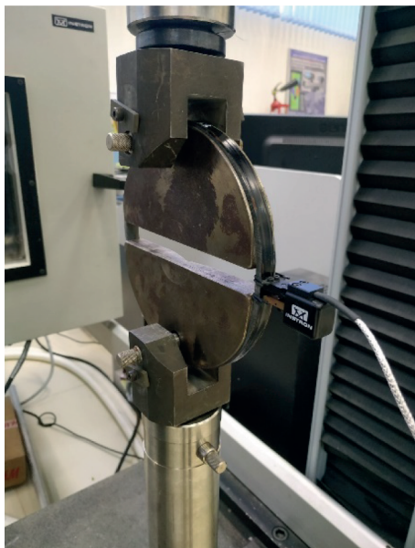
Рис. 2. Образец в захватах испытательной машины.
