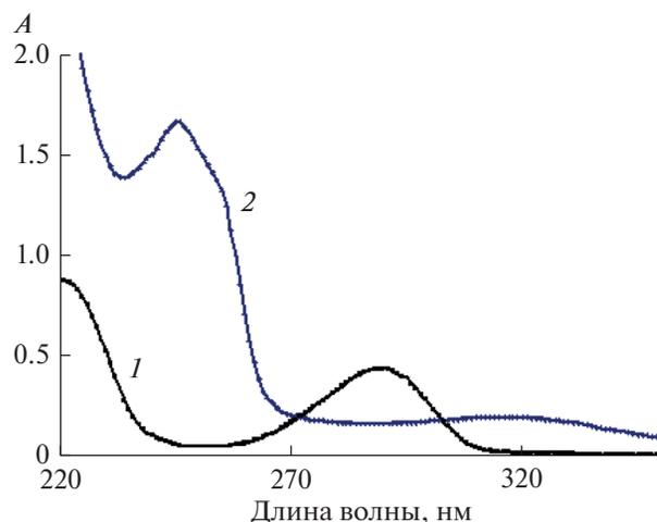
**Рис. 4.** Оптическая плотность  $A$  (отн. ед.) для исходного раствора гидрохинона концентрацией 22 мг/л (кривая 1) и через 2 дня после введения азотистой кислоты, смесь  $\text{H}_2\text{Q} + \text{NaNO}_2 + \text{H}_2\text{SO}_4$  (кривая 2).
