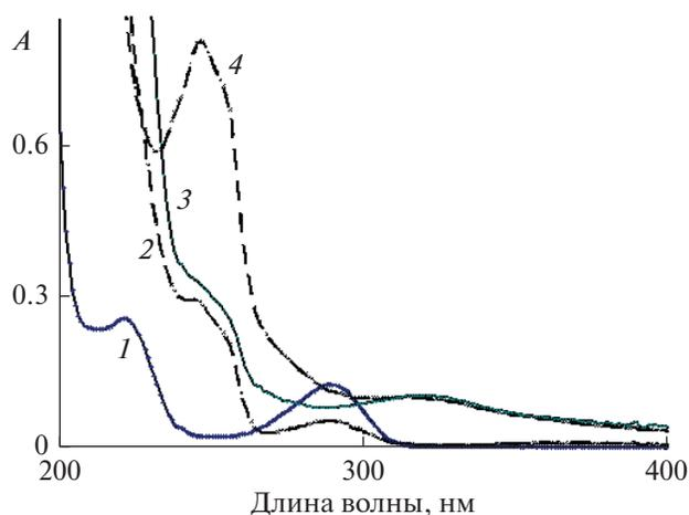
**Рис. 1.** Оптическая плотность  $A$ , относительные единицы, (absorbance) пробных растворов. 1 – спектр поглощения раствора гидрохинона концентрацией 40 мг/л; 2 – спектр раствора гидрохинона H2Q концентрацией 40 мг/л сразу после обработки импульсным излучением генератора ИР10 дозой 2100 Дж; 3, 4 – спектры смеси растворов H2Q (40 мг/л, 10 мл) + АПВ (10 мл), обработанной излучением генератора ИР10 дозами: 3 – 2100 Дж и 4 – 350 Дж на второй день после смешивания.
