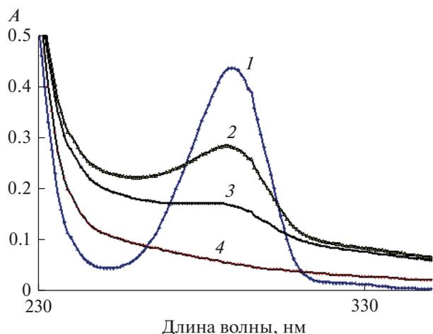
**Рис. 3.** Оптическая плотность  $A$  (отн. ед) раствора гидрохинона концентрацией 22 мг/л после обработки холодной плазмой коронного электрического разряда. 1 – исходный раствор, 2 – доза 600 Дж, 3 – 900 Дж, 4 – 1500 Дж, все дозы на 10 мл раствора.
