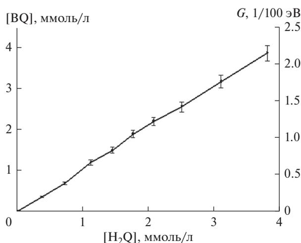
**Рис. 2.** Зависимость концентрации образующегося в реакции бензохинона [BQ], ммоль/л, и выхода окисления гидрохинона, G, 1/100 эВ, от концентрации гидрохинона [H2Q], ммоль/л, при дозе облучения 350 Дж. Концентрация активных частиц, образующихся в дистиллированной воде при такой дозе, равна 1 ммоль/л.
