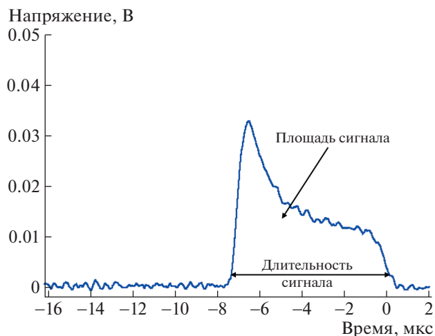
Рис. 7. Типичная форма сигнала от альфа-частицы в ВПК низкого давления.
