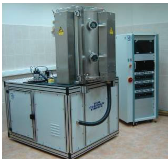
Рис. 1. Фотография и схема установки магнетронного напыления типа CFUBMS марки UDP-850 Teer Coatings Ltd. с ионным источником.
