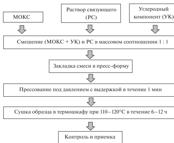
Рис. 2. Технологическая схема получения функциональных материалов и композитов высокой насыпной плотности на основе Cu-BTC.
