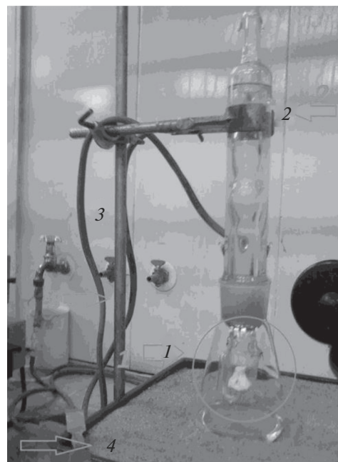
Рис. 2. Аппарат Сокслета для проведения десорбции бетулина с поверхности углеродной матрицы в этиловом спирте: 1 — экстрактор для аппарата Сокслета; 2 — холодильник; 3 — штатив; 4 — песчаная баня.
