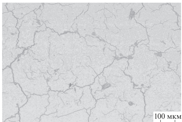
Рис. 7. Поперечный срез образца Д-16, полученного селективным сплавлением.
