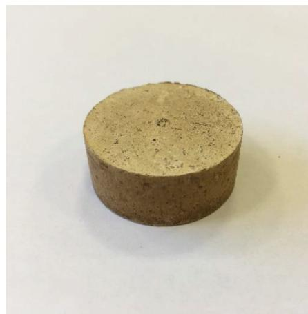
Рис. 7. Внешний вид функционального нанопористого материала Zr-BDC-ПВС. Давление формования 30 МПа; температура 298 К.
