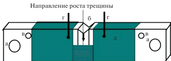
Рис. 2. Схема балочного образца для изучения скорости роста трещины: (а) отверстия для крепления в разрывной машине; (б) концентратор напряжений; (в) отверстия с резьбой для токоподводов; (г) контакты для измерения потенциала; (д) химически стойкий лак.
