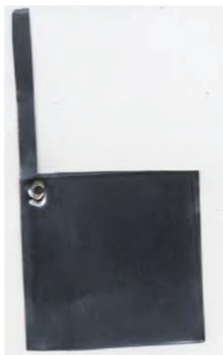
Рис. 5. Образец для проведения коррозионных испытаний в электролите.
