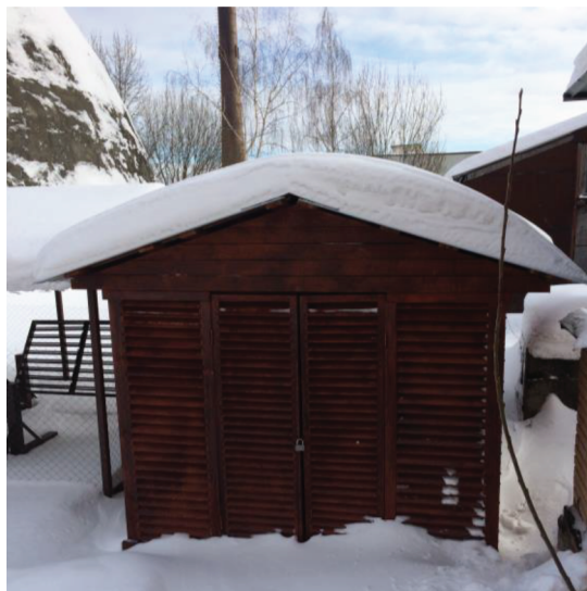
Рис. 3. Жалюзийная будка на испытательной площадке Московской коррозионной станции ИФХЭ РАН.
