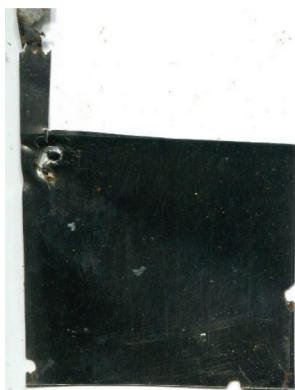
Рис. 22. Образец углеродистой стали, предварительно модифицированной в 1% растворе АС, после 32 сут коррозионных испытаний в 0.1 М NaCl.
