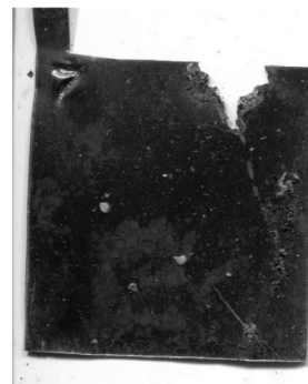
Рис. 25. Образец углеродистой стали, предварительно модифицированной в 1 мМ растворе БТА, после 32 сут коррозионных испытаний в 0.1 М NaCl.
