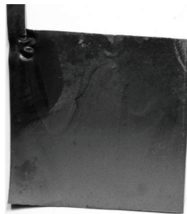
Рис. 19. Образец углеродистой стали, предварительно модифицированной в 1% растворе ВС, после 32 сут коррозионных испытаний в 0.1 М NaCl.
