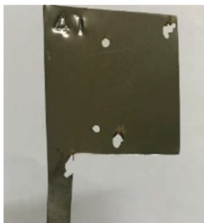
Рис. 18. Образец немодифицированной углеродистой стали, после 32 сут коррозионных испытаний в 0.1 М NaCl.
