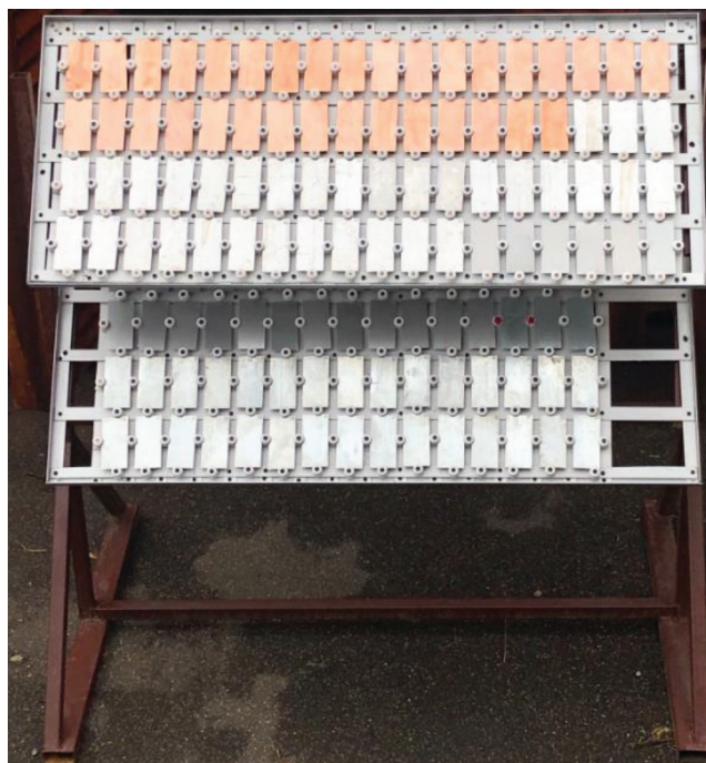
Рис. 4. Испытательный стенд для проведения натуральных коррозионных испытаний в городской атмосфере.
