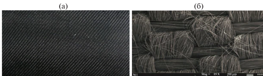
Рис. 3. Фотография исходной ткани типа “Бусофит” без покрытия. (а) Обычное фото, (б) снимок с электронного микроскопа.
